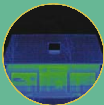
Kvalitne izolovaný obvodový plášť pasívneho domu bez tepelných strát.
