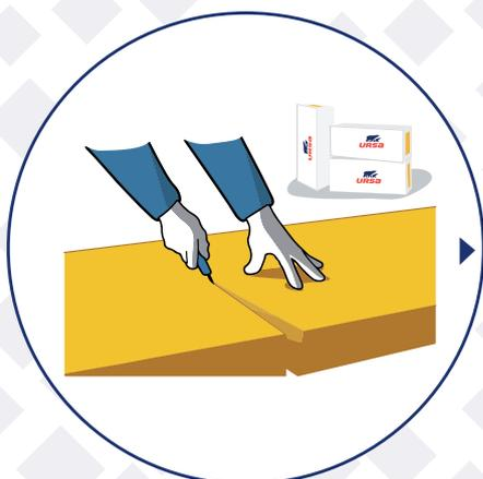
Odrežeme nameranú časť minerálnej izolácie URSA SILENTIO 33. Rez vykonávame pozdĺž príťažnej lišty (časť OSB dosky, kovový profil a pod.) Špeciálnym nožom URSA určeným na rezanie izolácie.
