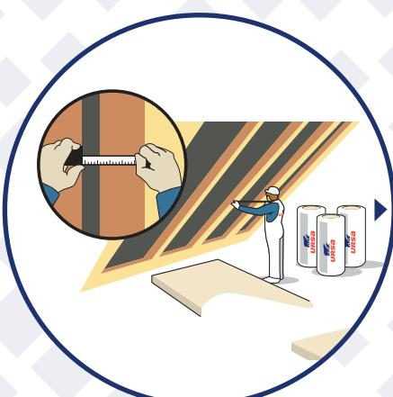
Zmeriame si potrebnú šírku izolácie medzi krovkami. Pre zabezpečenie lepšej fixácie minerálnej izolácie URSA PUREONE SF 31 medzi krovkami pridáme k nameranému rozmeru ešte 1 cm.
