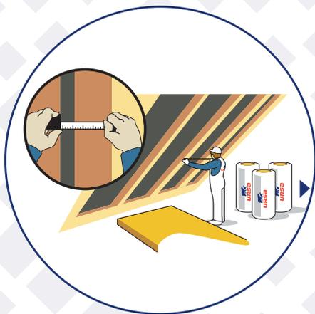
Zmeriame si potrebnú šírku izolácie medzi krokvi. Pre zabezpečenie lepšej fixácie minerálnej izolácie URSA PLATINUM 32 medzi krokvi pridáme k nameranému rozmeru ešte 1cm. Pre ľahšie rezanie je minerálna izolácia URSA PLATINUM 32 priečne potlačená ryskami (rozteč tlačných rýsiok je a 10 cm).
