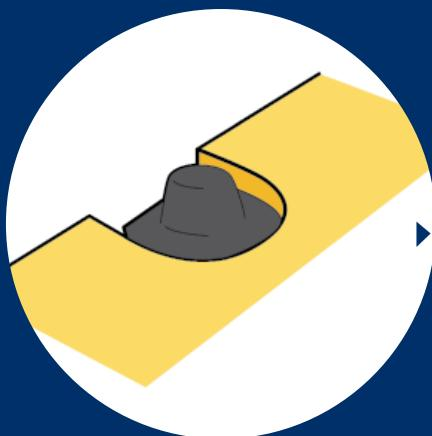
Pro každý prostup ve střešním pláště je potřeba vyříznout v desce dostatečně velký otvor tak, aby se případný prostup dal jednoduše začistit a zaizolovat především proti zatékání srážkové vody, ale byl i dostatečně tepelně izolován proti únikům tepla.
