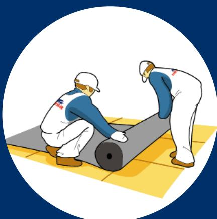
Aplikace krycí separační vrstvy. Na tu lze aplikovat finální povrch, kterým může být: pojízdná střecha, parkovací plocha, zelená střecha s extenzivní či intenzivní zelení apod.
