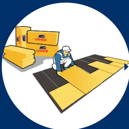
Desky pokládáme na suchý a čistý povrch hydroizolačního souvrství. Desky vedle sebe klademe s přesahem cca o polovinu délky.
