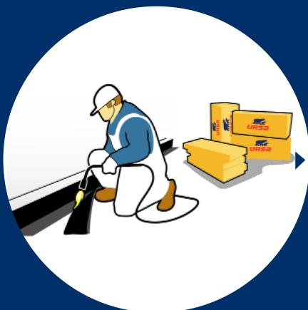
Desky si připravíme k aplikaci místu. Izolaci URSA XPS aplikujeme po dokončení hydroizolačních prací (hořáky určené k aplikaci hydroizolačních vrstev nesmí přijít do přímého kontaktu s URSA XPS).
